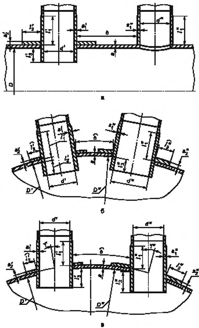
Рисунок А.8 — Укрепление взаимовлияющих отверстий
