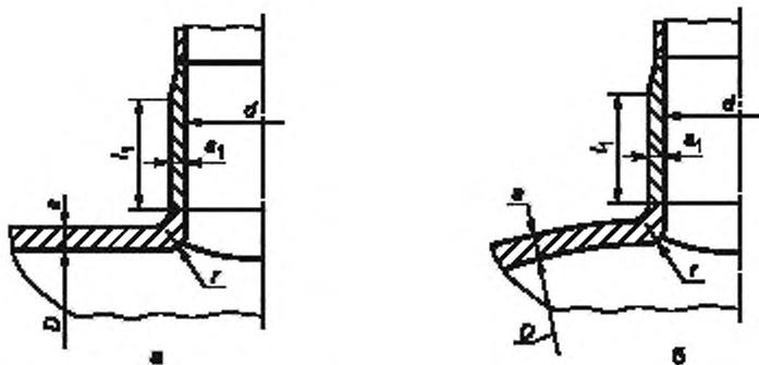
Рисунок А.6 — Укрепление отверстий отбортовкой
