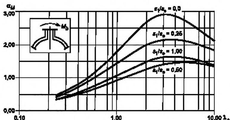
Рисунок Б.11 — Коэффициенты концентрации  $\alpha_M$  в месте пересечения штуцера со сферической оболочкой при нагружении штуцера изгибающим моментом в зависимости от  $\lambda_s$  и отношения  $s_1/s_3$
