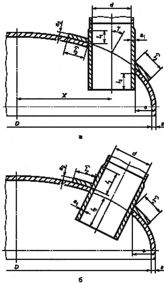
Рисунок А.13 — Смещенные штуцеры на выпуклом днище
