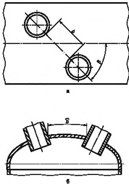
Рисунок А.10 — Общий случай расположения взаимовлияющих отверстий
