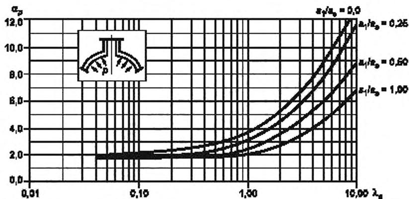
Рисунок Б.7 — Коэффициенты концентрации  $\alpha_p$  в месте пересечения штуцера со сферической оболочкой при внутреннем давлении в зависимости от  $\lambda_3$  и отношения  $s_1/s_3$
