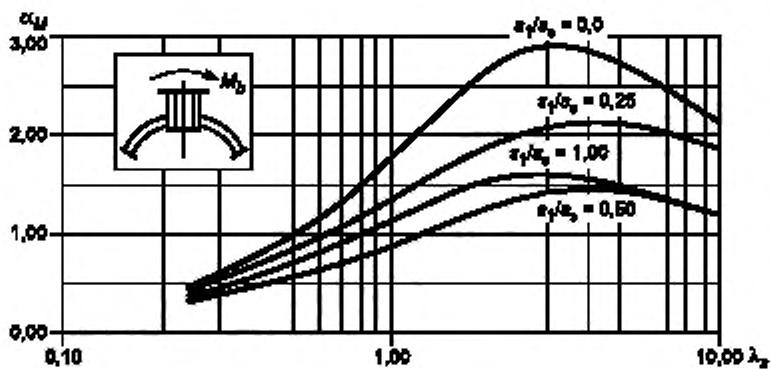
Рисунок Б.12 — Коэффициенты концентрации  $\alpha_M$  в месте пересечения проходящего штуцера со сферической оболочкой при нагружении штуцера изгибающим моментом
