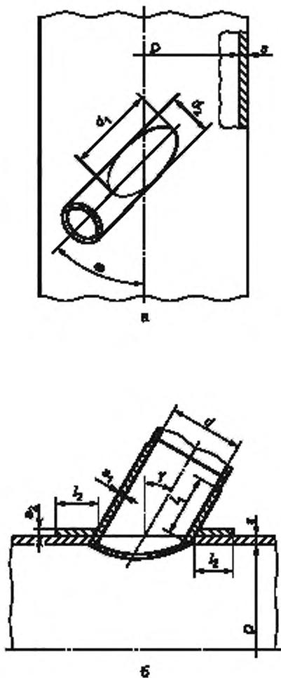
Рисунок А.11 — Наклонные штуцеры на обечайке
