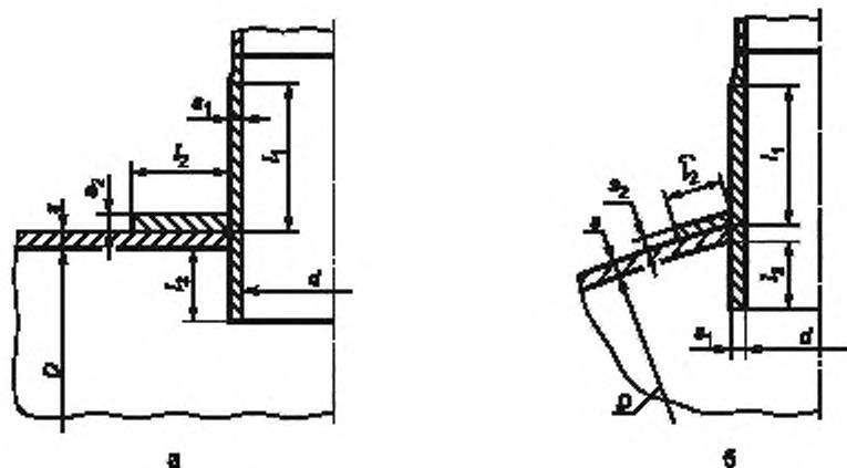
Рисунок А.5 — Укрепление отверстий накладным кольцом
