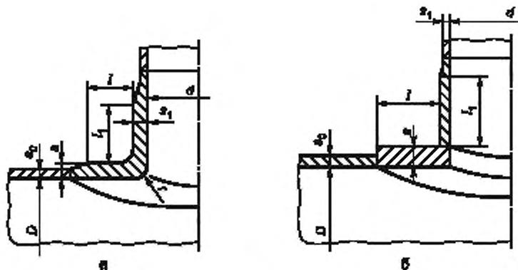
Рисунок А.7 — Укрепление отверстий торцообразной вставкой или вварным кольцом
