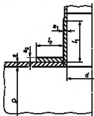
Рисунок А.4 — Укрепление отверстий накладным кольцом
