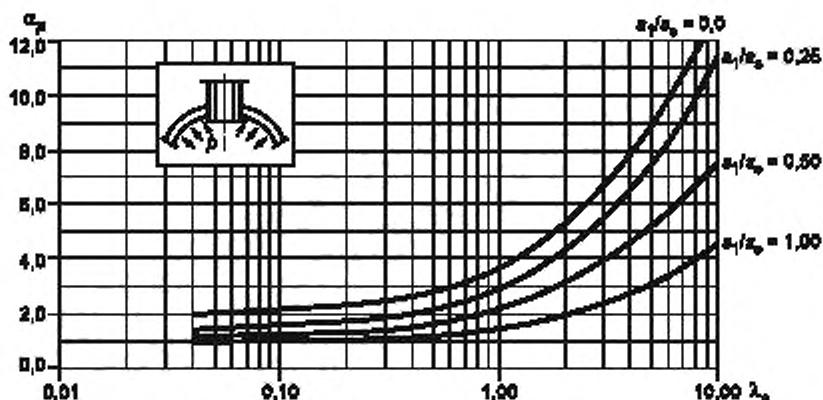
Рисунок Б.8 — Коэффициенты концентрации  $\alpha_p$  в месте пересечения проходящего штуцера со сферической оболочкой при внутреннем давлении в зависимости от  $\lambda_3$  и отношения  $s_1/s_3$
